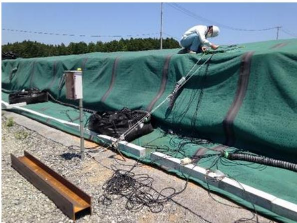
写真 3. 4-3 ケーブル張力測定装置
