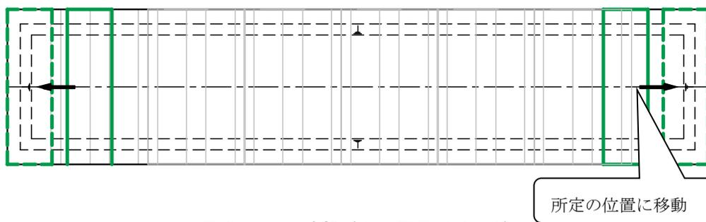
図 2.4-14 端部パネル設置イメージ
