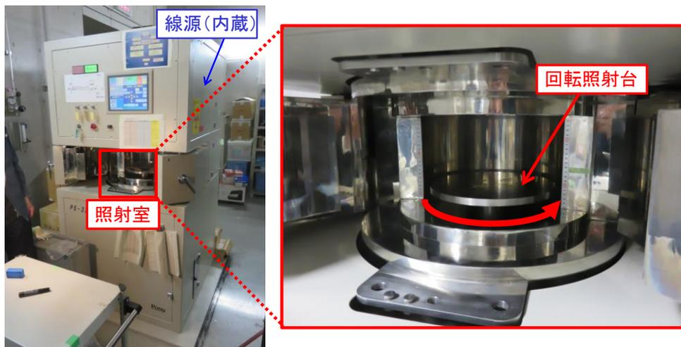
写真 4.1-1 <sup>137</sup>Cs- $\gamma$  線照射装置
