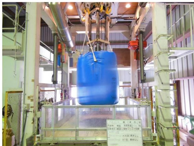
写真 4.2-3 繰返し頂部つり上げ試験状況
