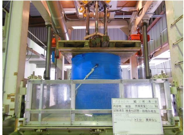
写真 4.2-4 積重ね試験状況
