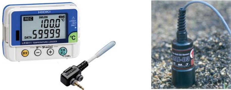
写真 3.1-2 温度計（左）と酸素濃度計（右）
