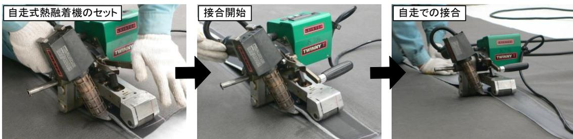
写真 2.1-6 自走式熱融着機による融着状況
