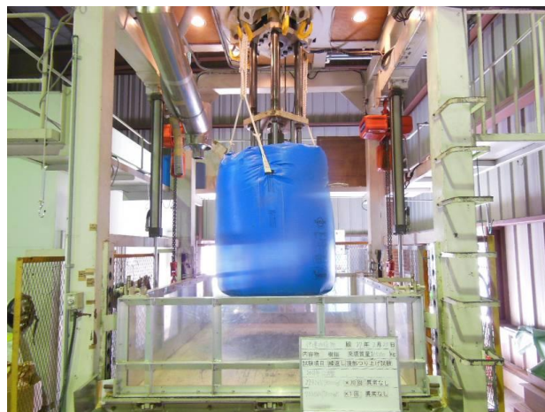
写真 4.2-3 繰返し頂部つり上げ試験状況
