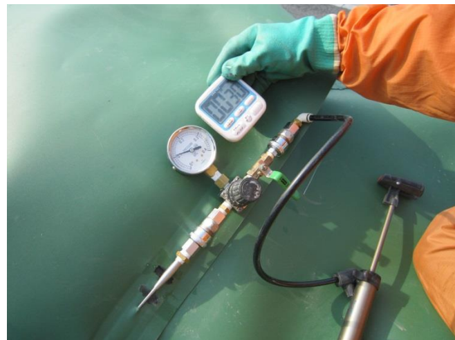
写真 2.4-8 加圧検査状況
