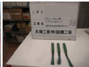
引張試験結果状況 (CP600と遮水シート)
