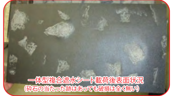
不陸地盤上に敷設された一体型複合遮水シートへの載荷試験
