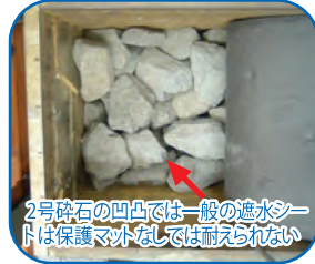
不陸地盤上に敷設された一体型複合遮水シートへの載荷試験
